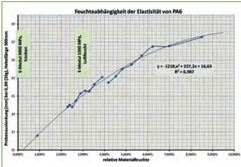
Bild 4: Abhängigkeit der Auslenkung einer Probe und damit des E-Moduls von der Konditionierung.
