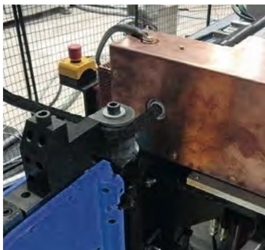
Bild 2: Das Halbzeug (nach Verformung im erwärmten Zustand) im Werkzeug.
