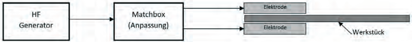
Schematischer Aufbau des Hochfrequenz-Heizsystems, das Umformwerkzeug ist nicht dargestellt.
