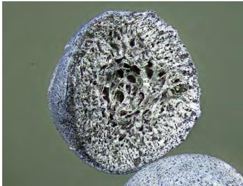
Poröse Struktur aus einem Querschnitt von APAK12.
