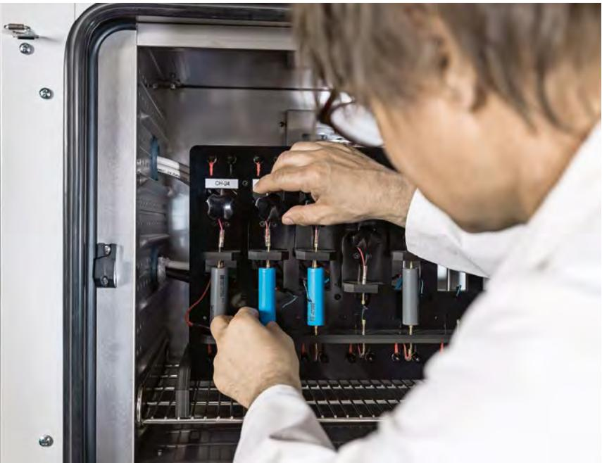
Pulsladeprüfstand, der in der AG Energiespeicher-systeme entwickelt wurde.
