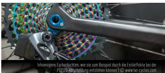
Inhomogene Farbschichten, wie sie zum Beispiel durch die Feldeffekte bei der PECVD-Abscheidung entstehen können | © www.tvr-cycles.com
