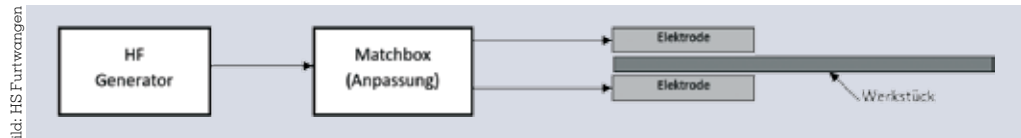
▲ Schematischer Aufbau des Hochfrequenz-Heizsystems (Umformwerkzeug nicht dargestellt).
