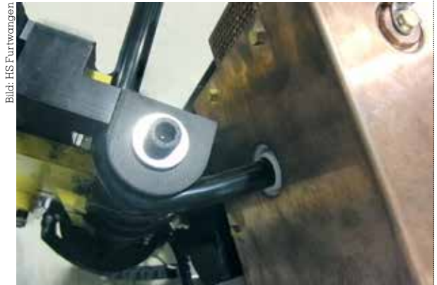
▲ PA6.12 Werkstück (hier Rohr) im Biegewerkzeug, das Heizsystem befindet sich rechts (Kupfer).
